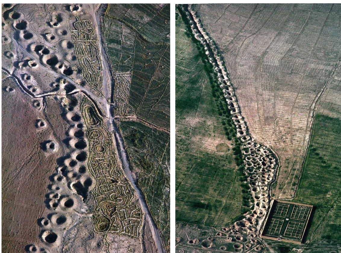
نمای هوایی زنجیره دهانه‌های مدوّر میله‌چاه‌ها که برای کندن آبراه‌های زیرزمینی به کار می‌روند تصویر ۲) استان فارس، ۲۸ فروردین ۱۳۵۵ تصویر ۳) دشت بیشاپور، استان فارس، ۴ مهر ۱۳۵۶ (عکاس: گئورگ گِرسِتِر، مأخذ: مریم زاکس)
